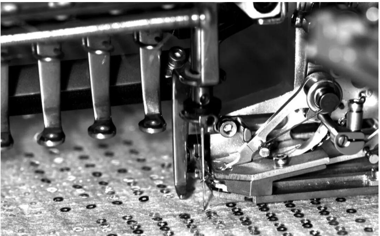
Figura | Osservazione dell'azione di infilatura dell'ago nei macchinari tessili
