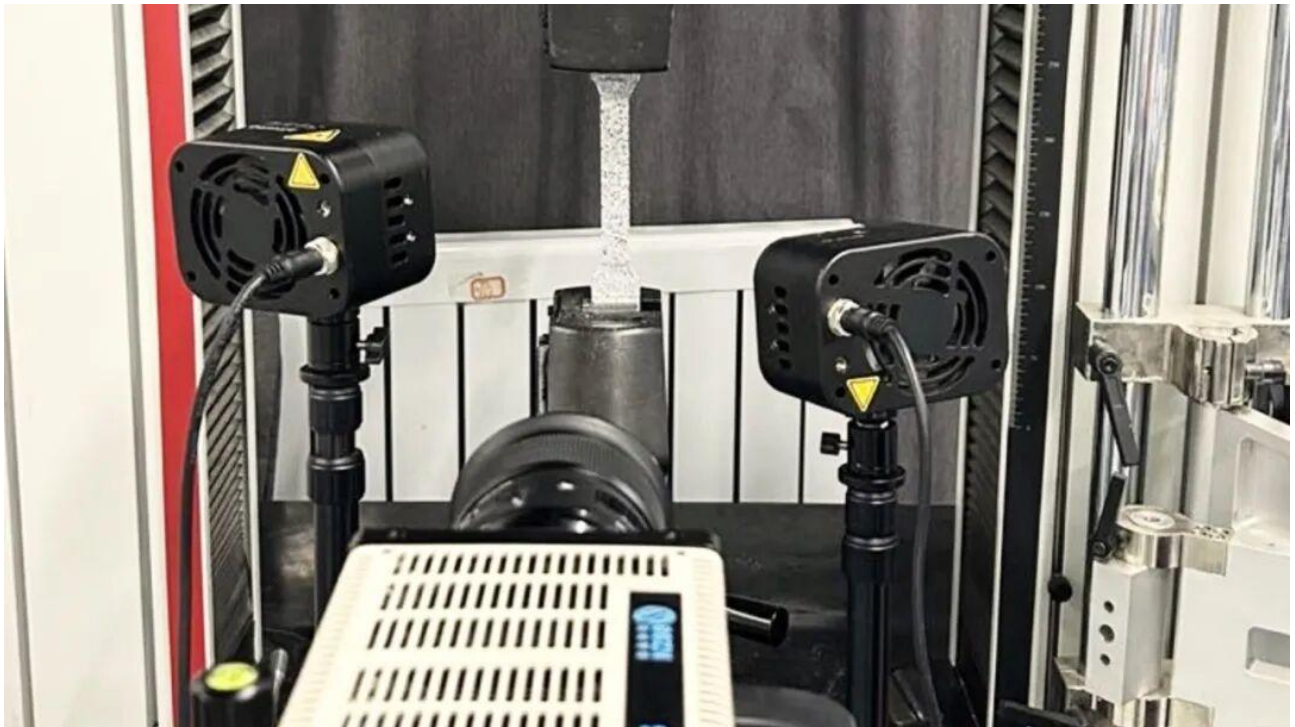
Figura | Osservazione del test di trazione su materiale composito
